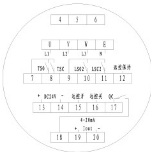
Q 系列整体隔爆型端子接线图
